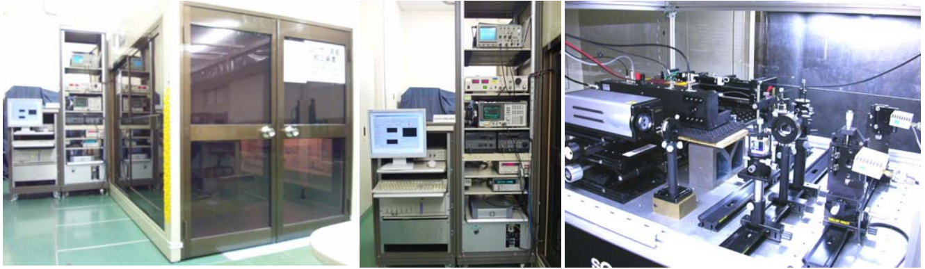
長さ測定用レーザー(633nm)の波長校正装置
